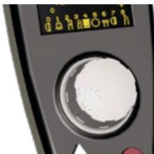
Das Drehen des Fahrreglers dient zur Änderung der Lokgeschwindigkeit. Ein Druck auf den Fahrregler führt zu einem Nothalt der aktuellen Lok und, bei gewähltem AC - Fahrreglermodus (Werkseinstellung), zur Umkehr der Fahrtrichtung.
